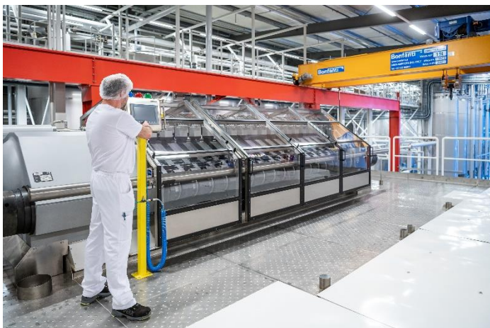
In der Butterpresse wird die frisch verarbeitete Bio-Kakaomasse schonend gepresst und die flüssige Kakaobutter vom festen Presskuchen für die Kakaopulverherstellung getrennt. (Bild: © PRONATEC AG)
